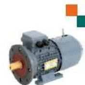
Cuando la bobina electromagnética del freno es desenergizada, es decir que se desconecta la alimentación eléctrica del motor, la fuerza de atracción que la misma producía desaparece, el resorte se descomprime y aplica nuevamente la presión a los platos de metal, actuando a su vez sobre el disco de freno deteniéndolo junto con el eje.
